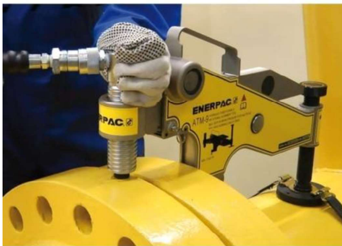
Слика 8. Механички алат за поравњање прирубница
